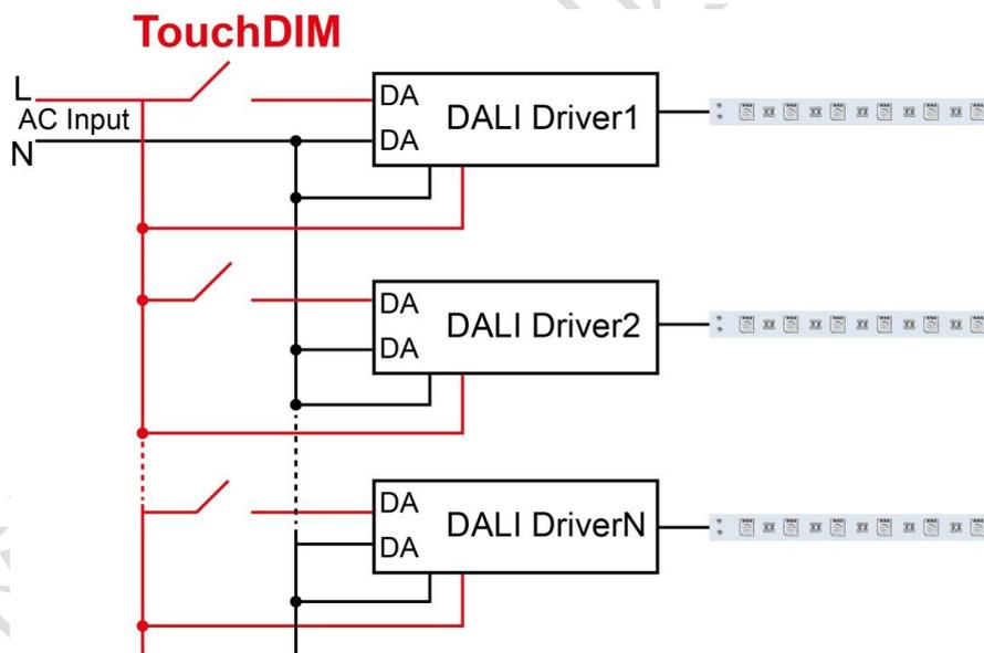
**备注：**只能使用开路的按压式开关（不带指示灯）。采用同步连线时每个设备和设备之间的线长不超过 20 米。
